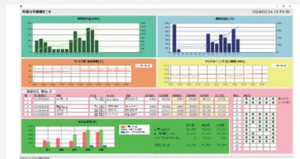
業務管理に使用している稼働モニタ。工場の稼働状況と電気・水道・ガスなどの資源の投入状態が一つの画面上で把握できる。
